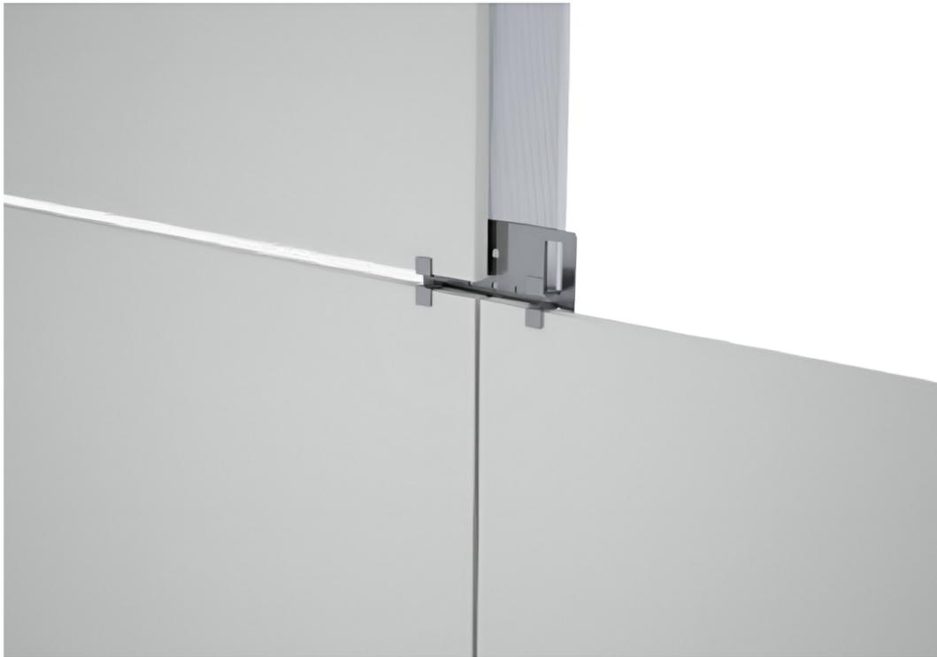
Además dispone un cordón de masilla elastomérica tipo MS entre toda la superficie de contacto entre la placa y el perfil vertical que aporta una mayor seguridad en caso de rotura y para absorber vibraciones del viento y dilataciones. Admite espesores de 6 mm y 12 mm.
