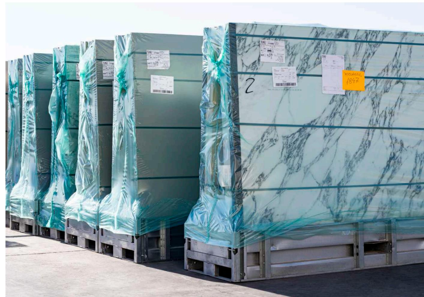
I cavalletti con le lastre Ascale vanno caricati, scaricati e trasportati utilizzando un carrello elevatore a forche, una gru o un altro dispositivo di manipolazione adeguato.
